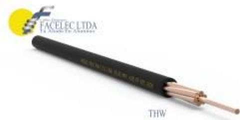
**THW:** Thermoplastic Insulation, Heat Resistant (75°C), Suitable for Wet Locations Aislamiento termoplástico resistente al calor (Conveniente para los lugares húmedos). Este conductor se diferencia de los THHW por tener una resistencia al calor más baja, su temperatura de operación máxima es de 75°C, para los THHW es de 90°C. Cable monopolar de cobre, aislado en policloruro de vinilo (PVC) 75°C Tensión máxima de 600 voltios
