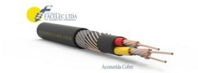
Conductor o conductores de aluminio serie 8000 o cobre suave, aislado (s) en materiales como PVC, LDPE, XLPE, con neutro distribuido concéntricamente sobre las fases y con una chaqueta común resistente a los rayos ultravioleta. Tensión máxima, 600V.
