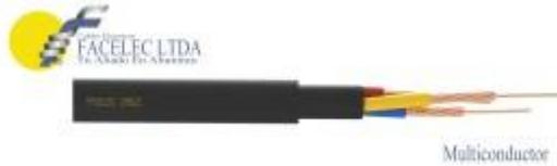
Conductores de cobre suave, aislados en materiales como PVC, LDPE, XLPE, con neutro cableado con las fases y bajo una chaqueta común resistente a los rayos ultravioleta. Tensión máxima, 600V.
