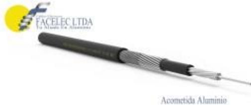
Conductor o conductores de aluminio serie 8000 o cobre suave, aislado (s) en materiales como PVC, LDPE, XLPE, con neutro distribuido concéntricamente sobre las fases y con una chaqueta común resistente a los rayos ultravioleta. Tensión máxima, 600V.
