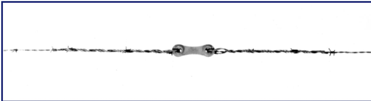
El Seccionador Preformado para Cercos - SCM se destina a seccionar eléctricamente el alambre de púas o el liso, en los alambrados que corren paralelamente o son cruzados por las líneas de transmisión o distribución de energía eléctrica. Su función es evitar que el energizado accidental del alambrado pueda poner en riesgo de vida a personas o animales.
