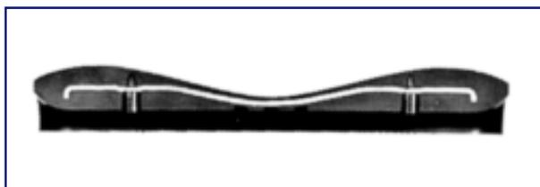
El manguito de elastómero está constituido de material resistente al ozono y demás condiciones específicas del lugar y posee un refuerzo interno de aluminio que mejora su desempeño en la distribución de esfuerzos en el cable conductor. La fijación a la cadena de aisladores se realiza utilizándose herrajes convencionales, tales como: órbita-ojal, horquilla-ojal, etc. Se debe prestar especial atención en cuanto al ajuste entre las dimensiones del ojal y las dimensiones de las zapatas de la AGS®.
