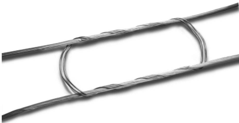
El Espaciador Helicoidal Preformado - SUMS aplicado en un sistema de 2 conductores por fase, dispuestos horizontalmente, es utilizado para mantener la separación y estabilidad del haz de subconductores y oscilaciones de subvano de las líneas de transmisión, consiguiendo:
