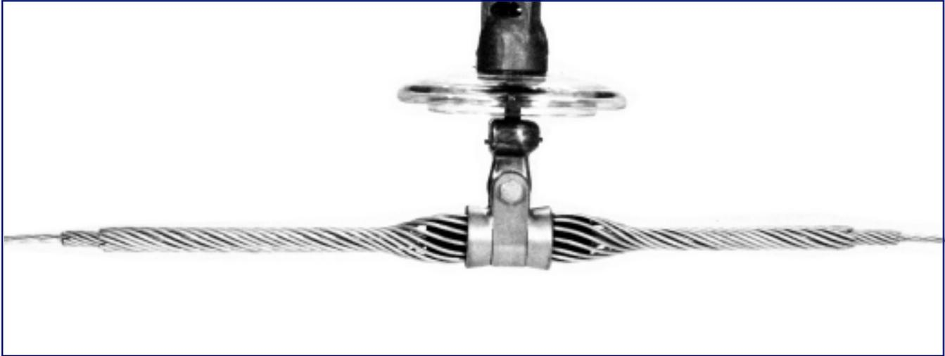
Para reparación de conductores dañados en el punto de suspensión, se puede aplicar una AGS especial sobre la armadura preformada **AR** para prolongar la vida del conductor.
