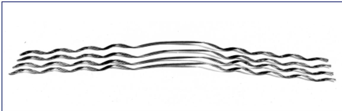
La Reparación Preformada Splice Shunt – SS tiene la finalidad de prevenir el sobrecalentamiento en un empalme convencional a compresión instalado que, con el pasar de los años, comienza a desarrollar resistencias anormalmente elevadas.
