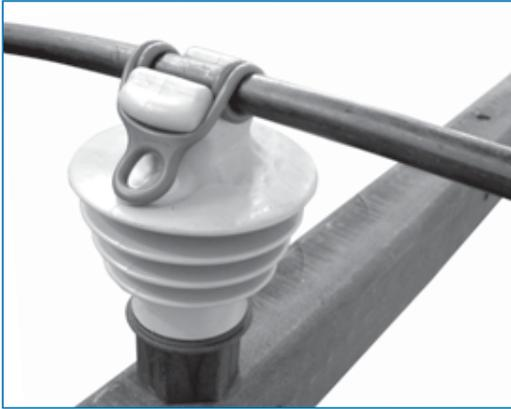
El Aislador Pilar Polimérico es utilizado en redes de distribución de energía eléctrica con cables desnudos ó protegidos, clase de tensión 15 KV, que exigen mayor NPI.
