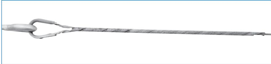
La Retención Preformada para Cables de Acero – GDE se destina al anclaje de cables de acero galvanizado y cables de acero recubiertos de aluminio respectivamente, sujetos a esfuerzos de tracción sin torsión. Dependiendo del caso, debe ser utilizada en conjunto con guardacabo ó guardacabo con horquilla.
