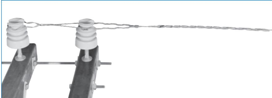
La Retención Doble Preformada de Distribución - DGD tiene la finalidad de encabezar el tendido de conductores en el primario de las redes de distribución y en electrificación rural, cuando se utilizan dos aisladores de perno fijo en estructuras con crucetas dobles para distribuir el esfuerzo de anclaje de los conductores de manera uniforme en los dos aisladores.
