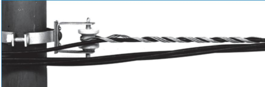
La Retención Preformada se destina al anclaje del conductor neutro desnudo ó recubierto de los cables preensamblados en la entrada al consumidor ó en las redes de distribución. Se aplica directamente sobre el aislador roldana.
