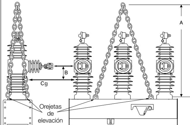
**A:** Altura de eslinga para unidades de 15 kV y 27 kV con BIL de 125: 914 mm (36 pulg)
