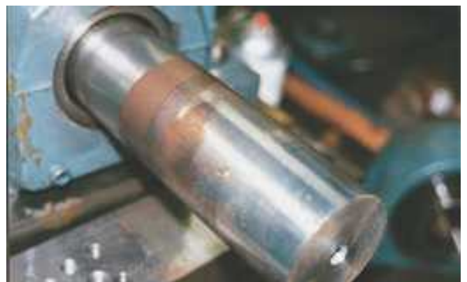
Rodamiento de tornillo de fijación después de 500 horas
