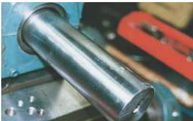
Rodamiento IMPERIAL después de 2500 horas
