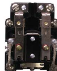
Contacto de transferencia
