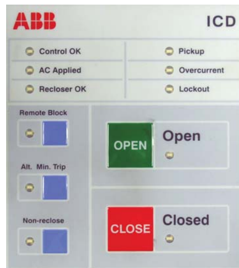
La HMI del ICD tiene botones indicadores grandes que son fáciles de leer, ver y usar
