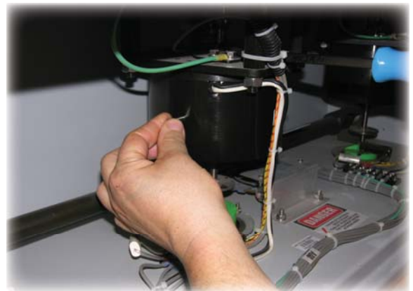
Los indicadores de desgaste proporcionan indicación simple pasa / no pasa cuando se necesitan cambiar las botellas de vacío eliminado mantenimiento
