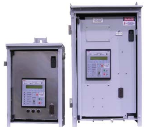
Los gabinetes LPCC (izquierda) y estándar se fabrican con acero inoxidable 304 y se suministran con protección de goteo, panel giratorio para acceso al cableado y puerta (no mostrada).
