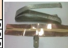
**NOTA:** Cables con pantalla en cinta requieren kit a tierra, cables con pantalla en hilos (neutro concéntrico) no requieren.
